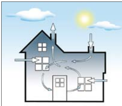
God ventilation sänker luftfuktigheten.
