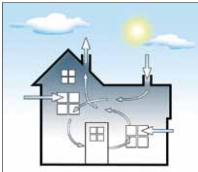
God ventilation sänker luftfuktigheten.
